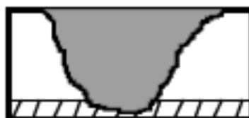
Figura 13 – Exemplo de Brecha resultante de falha nas fundações (Fonte: COLLISCHONN, 1997, p. 33)
