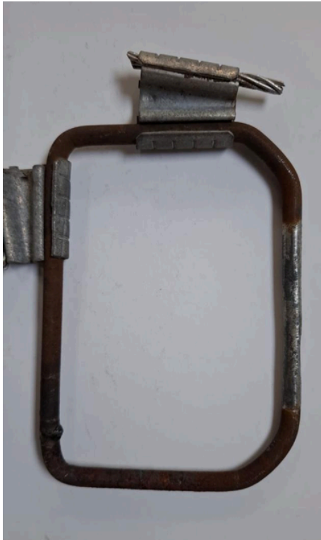
Figura 1: Estribo NÃO CONFORME – Fabricado em aço (ferroso) enferrujado.
