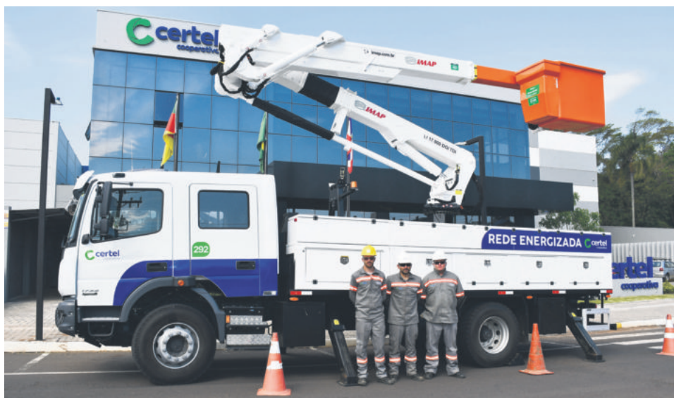
As intervenções acontecem sem causar a interrupção do fornecimento de energia aos associados
