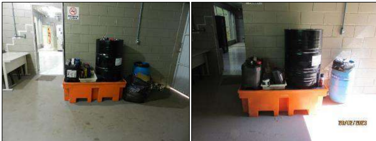
Figura 9 - Armazenamento de óleo lubrificante e resíduos perigosos em pallet contentor.
