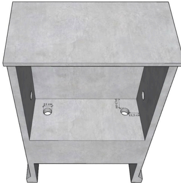
Figura 6: vista interna do fundo da cabine de medição com as principais dimensões
